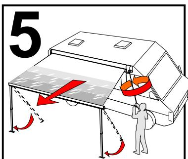
**DE** **Achtung Sicherheit** Das Endstück des Stützfußes A wurde so entwickelt, dass ein falsches Positionieren in der Frontblende (wodurch sich die Frontblende nicht korrekt schließen würde) während der Markisenschließung verhindert wird; es wird daher empfohlen, dies auf die richtige Art und Weise, mit der Basis zur Front hin, zu positionieren.
