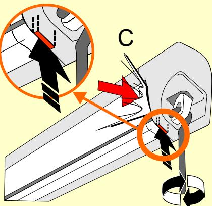
**DE** Bei komplett eingefahrener Markise ist die rote Anzeige nicht mehr sichtbar. Die Markise ist jetzt verriegelt. Die Verriegelung erfolgt ohne spürbaren Widerstand.
