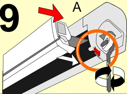
**DE** Bei ausgefahrener Markise ist die rote Anzeige sichtbar.
